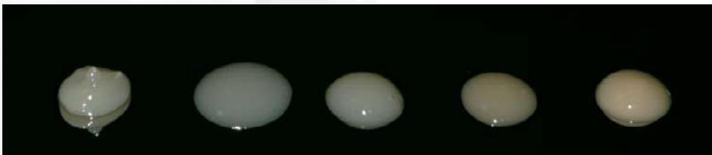
Imagen de varias resinas compuestas antes de la polimerización posicionadas sobre una superficie que fue posteriormente inclinada en un ángulo de 90°. De izquierda a derecha, Palfique Estelite (JMorita) high flow, medium flow y low flow, Eco Flow (Ivoclar Vivadent) y Aster Flow (Kiyomi).
